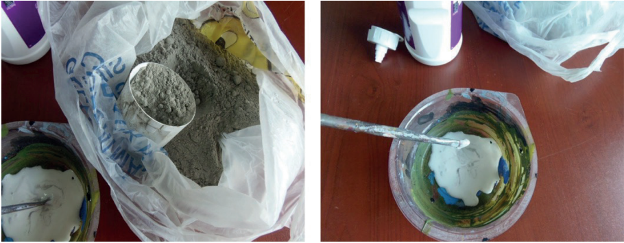
Görsel 2. Ağaç tutkalı (PVA) ve inşaat çimentosunun, akrilik boya kıvamına (viskozitesine) gelene kadar karıştırılması gösterilmektedir.
