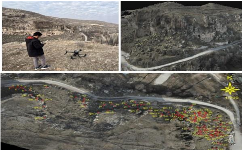
Şekil 7. Sol üstte, 2B ve 3B model ve haritalama çalışmaları, sağ üstte 3B model üzerinde işaretlenmiş kaya düşmesi kaynak alanlar ve altta ise ortofoto üzerinde işaretlenmiş kaya düşmesi kaynak alanların konumları.
