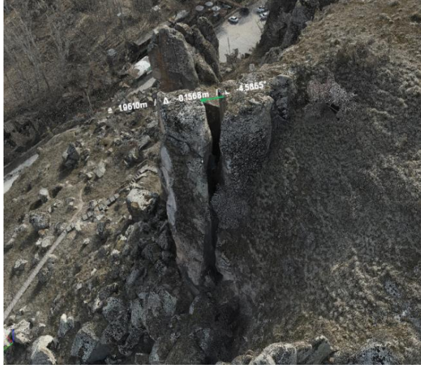
Şekil 4. Direkli kilise mevkiinde süreksizlik açıklığı örneği (açıklık yaklaşık 2 metre).
