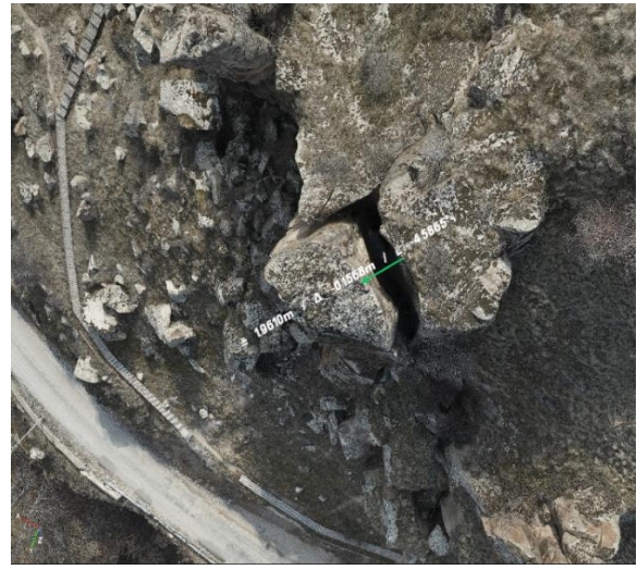
Şekil 4. Direkli kilise mevkiinde süreksizlik açıklığı örneği (açıklık yaklaşık 2 metre).
