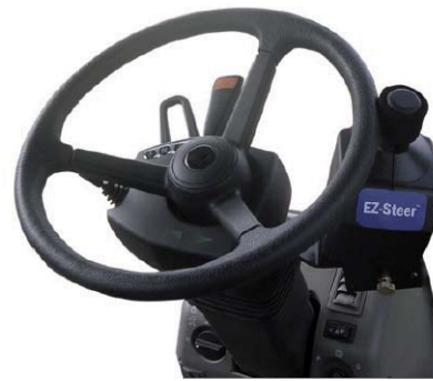
Şekil 3. Aktüatörlü EZ dümenleme (Trimble, 2005)
