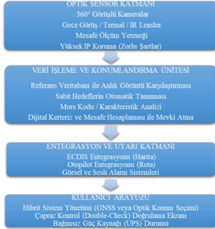
Şekil 4. Katılımcı beklentileri doğrultusunda oluşturulan GNSS bağımsız optik konumlandırma sisteminin kavramsal mimarisi
