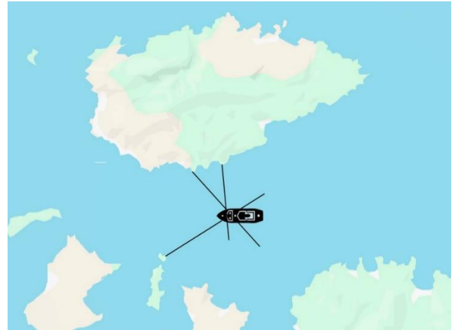
Şekil 3. Üç kerteriz ile mevki koyma (Orijinal) Figure 3. Positioning with three bearings (Original)
