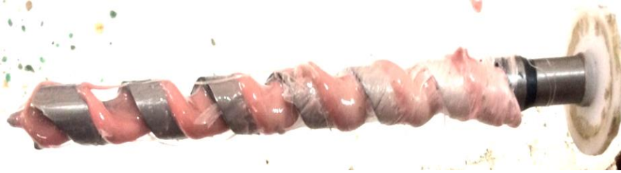
Şekil 7. Enjeksiyon mumunda gözlemlenen yapışma
