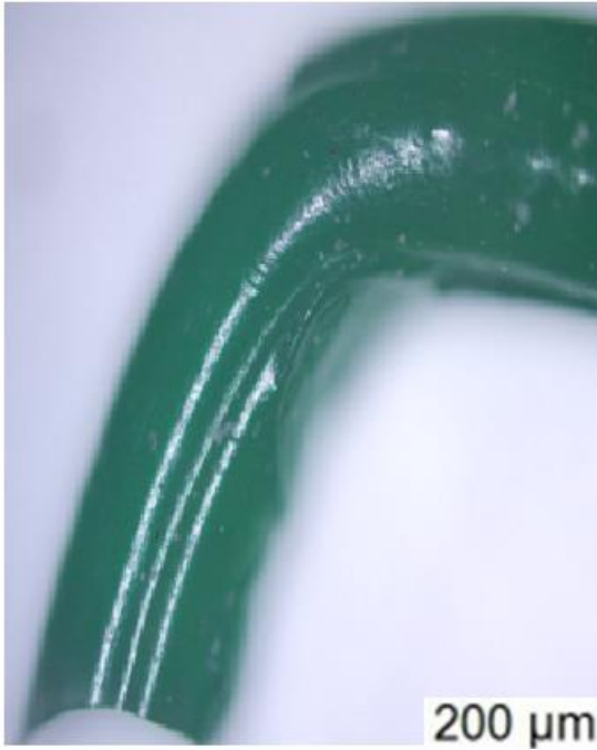
(a) Modelaj mumunun kırılmadan esneyebilme özelliği (0,6mm çapındaki nozul)
