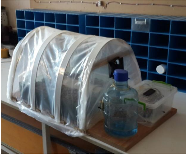
Şekil 4. Alttan kök ısıtmalı bir sera otomasyon sistemi prototipi
