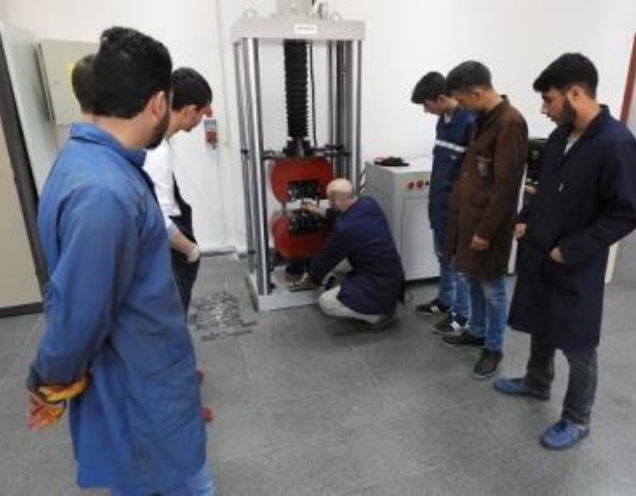
Şekil 6. Çekme-eğme test cihazı ile gerçekleştirilen uygulama
