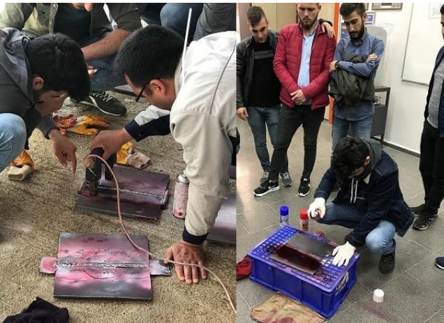
Şekil 8. Manyetik ve sıvı penetrant deneyleri
