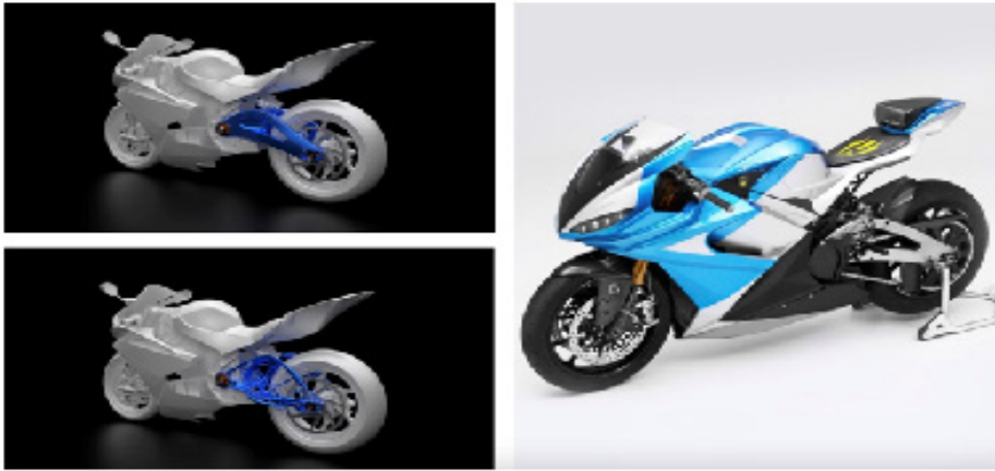
Şekil 5. Üretken tasarım ile geliştirilen motosiklet salıncak kolu tasarımı [15].
