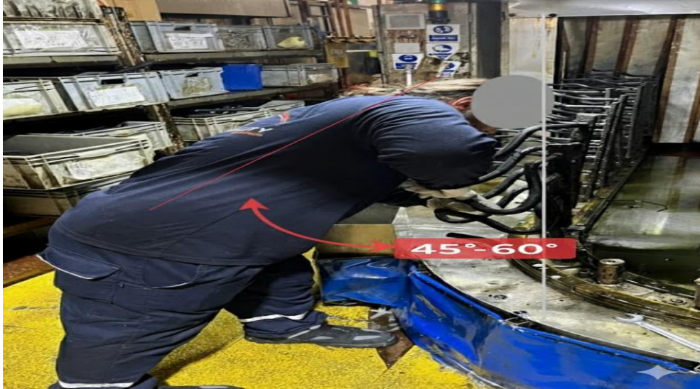
Şekil 9. Kauçuğun mandirene manuel olarak el ile takılma anı (The rubber is attached to the chuck manually by hand.)
