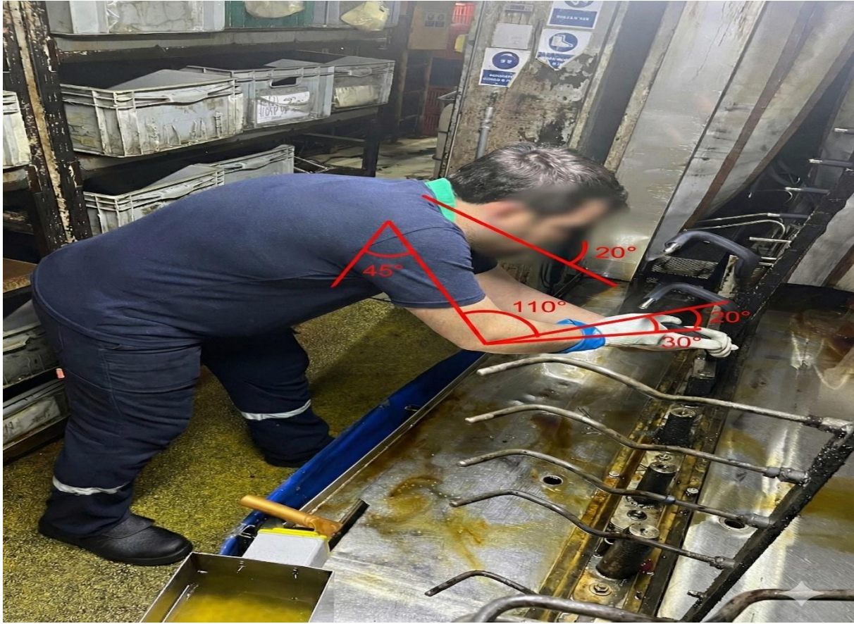
Şekil 12. Kauçukların manuel olarak çıkartılma anı (The moment of the rubber seals are manually removed.)
