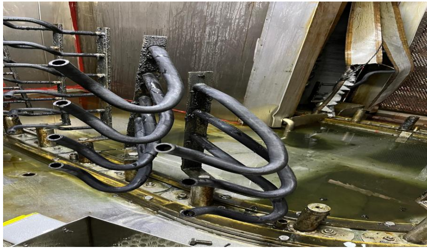
Şekil 8. Mandirenler ve kauçuklar (Chucks and rubbers)
