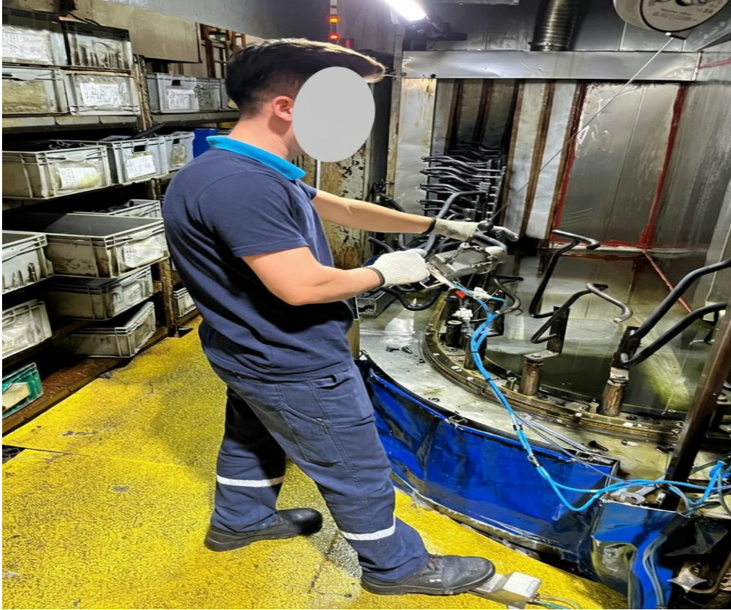
Şekil 14. Pompa yardımı ile kauçukların takılması (Installing rubber seals with the help of a pump)
