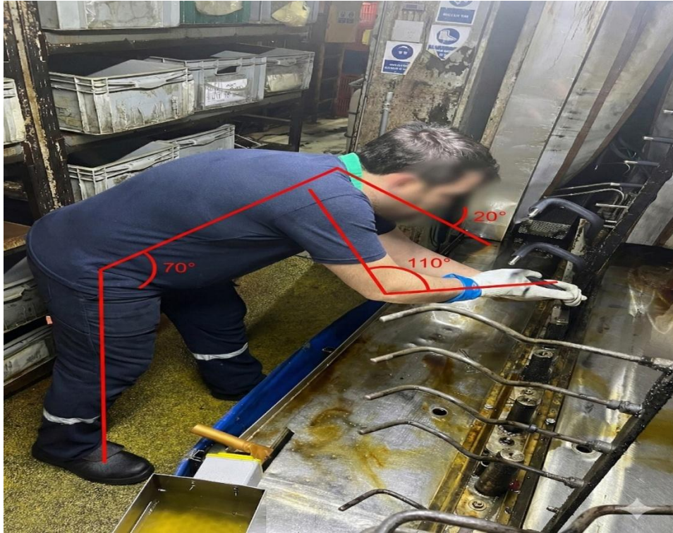
Şekil 11. Kauçukların manuel olarak çıkartılma anı (The moment the rubber seals are manually removed.)
