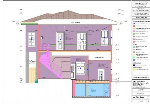
Şekil 36. A-A kesiti Hasar analizi örneği
