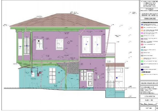
Şekil 35. Batı cephesi hasar analizi örneği
