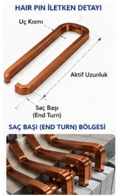
Şekil 1 Hair Pin iletken detayı
