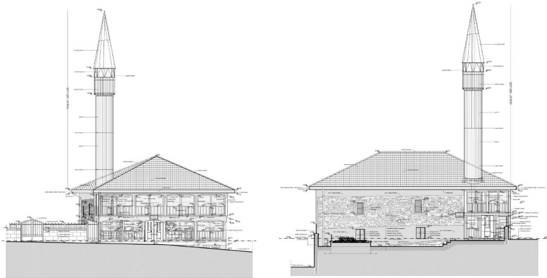
Şekil 26. a. Restorasyon Kuzey Cephe [10], b. Restorasyon Doğu Cephe [10]
