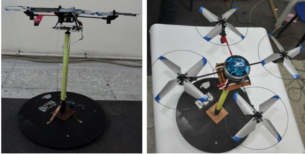
Şekil 8. Metal desteklerle güçlendirilmiş test platformu
