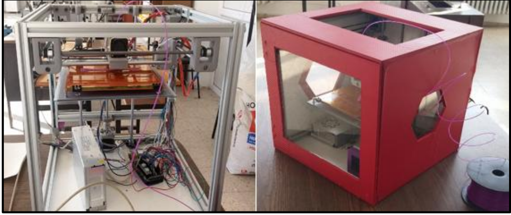
Şekil 2: Prototipi yapılan 3 boyutlu yazıcının etrafı açık ve kapalı haldeki görüntüleri
