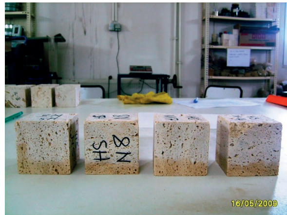
Şekil 4a. Kapiler su emme deneyi sırasında tabandan su almış örneklerin görünümü.
