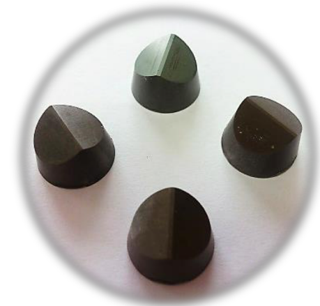
Şekil 3.8. Çalışma sonucunda pilot ölçekte üretilen endüstriyel SiAlON-TiN kesici uçlar
