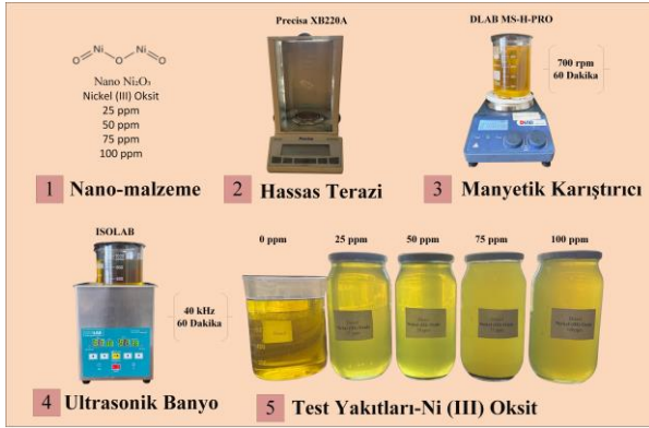
Şekil 2. Ni 2 O 3 katkılı eurodizel test yakıtlarının hazırlanış aşamaları
