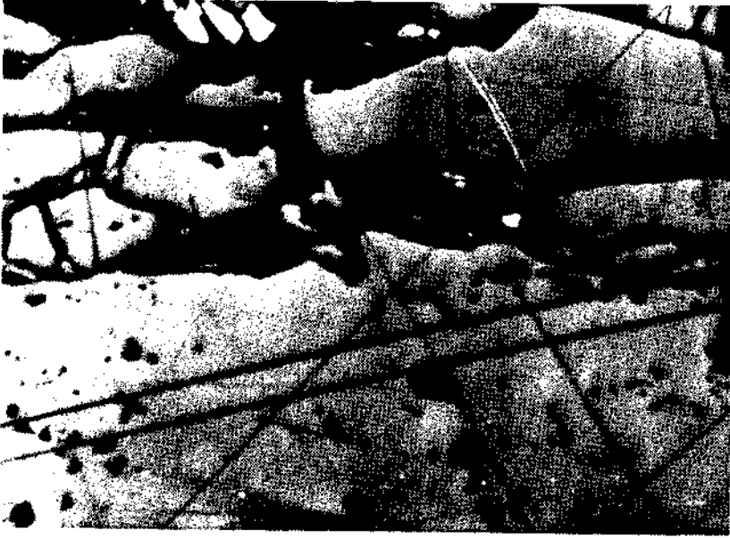
Foto 1 - Büyültme \times 250 (gliserinde). Kataklastik tekstür gösteren tetrahedrit (gri) ve çatlakları dolduran gang mineralleri (siyah).
