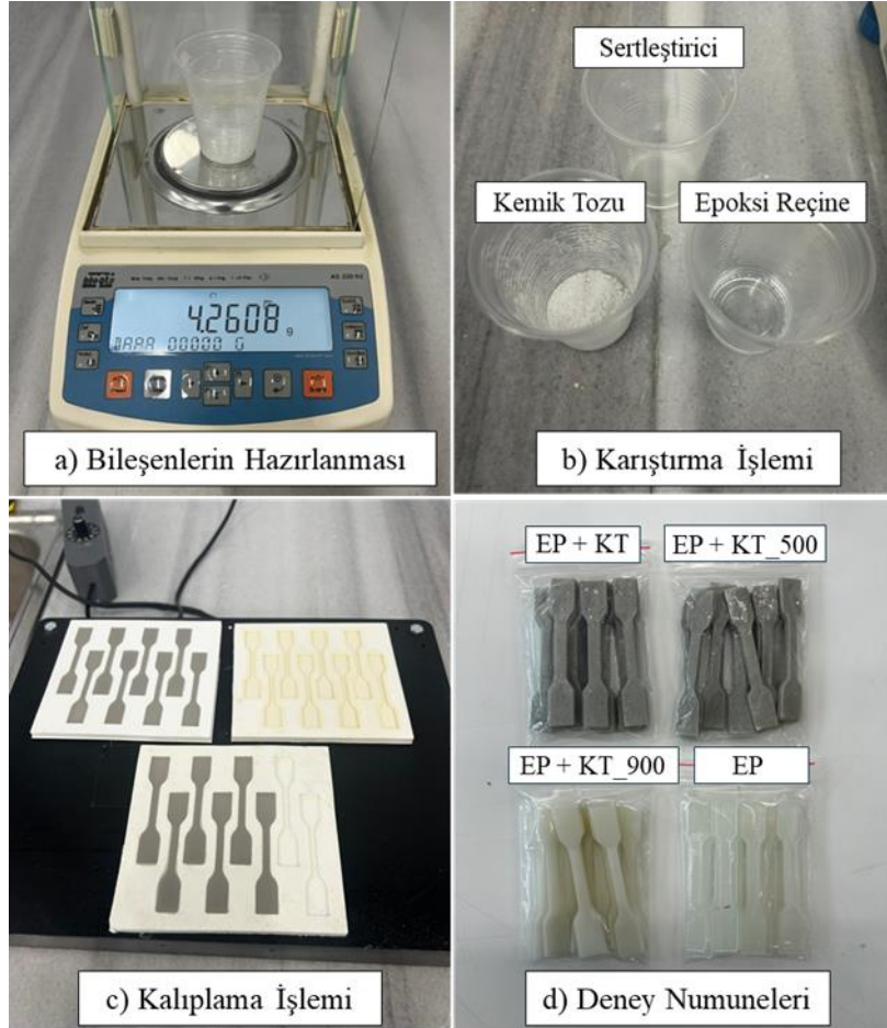
Şekil 2. Kompozit numunelerinin üretim aşamaları
