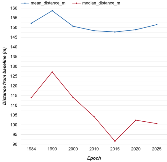
Figure 7. Mean and median shoreline distances for the seven primary shoreline epochs used in the 1984–2025 analysis. / Şekil 7. 1984–2025 analizinde kullanılan yedi ana kıyı çizgisi dönemi için ortalama ve medyan kıyı çizgisi uzaklıkları.
