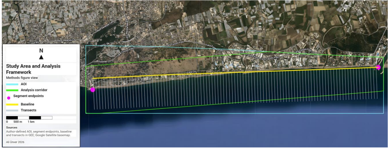
Figure 2. Study area and analysis framework showing the area of interest (AOI), shoreline analysis corridor, baseline, segment endpoints, and shore-normal transects used for shoreline-change calculations. / Şekil 2. Kıyı çizgisi değışim hesaplamalarında kullanılan ilgi alanı (AOI), analiz koridoru, başlangıç çizgisi, segment uç noktaları ve kıyıya dik transektleri gösteren çalışma alanı ve analiz çerçevesi
