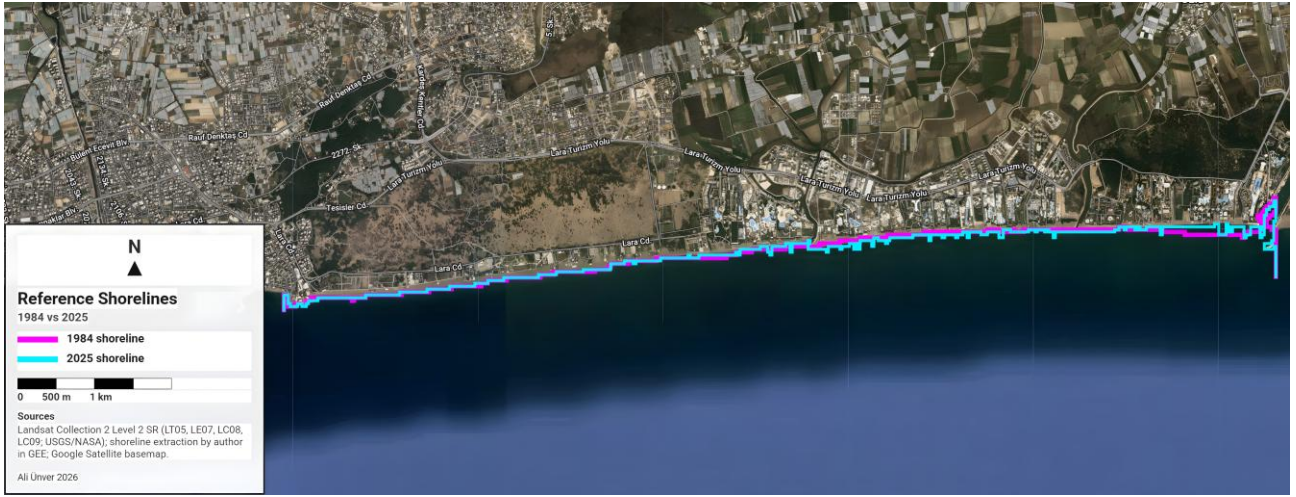
Figure 5. Comparison of the 1984 and 2025 reference shorelines along the Lara Beach study reach. / Şekil 5. Lara Plajı çalışma alanı boyunca 1984 ve 2025 referans kıyı çizgilerinin karşılaştırılması.
