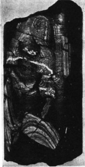
Foto 9 - Asfaltik materyelden bir sondaj karotu.
