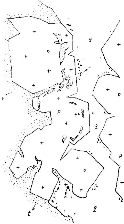
Şek. 2 - Kristal içine dağılmış rutil (?) taneleri (r) ile kuvars III (q) tarafından çimentolanmış agregat teşkil eden pirit kristalleri (p). Buradaki piritte, kuvarsin sebep olduğu herhangi bir metamorfizma görülmemiştir. Tetrahedrit (t) aynı zamanda bazı pirit zonlarının metasomatizması ile pirit agregatlarını da çimentolanmıştır. Büyütme : 120 x.
