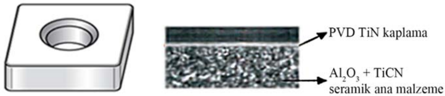
Şekil 1. Kullanılan karma-seramik uçlara ait tabakalar (Layers of the mixed ceramic inserts employed)
