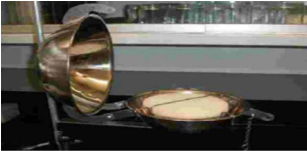
Şekil 3. Dış ortam pasif hava örnekleyicisi (Outdoor passive air sampler)
