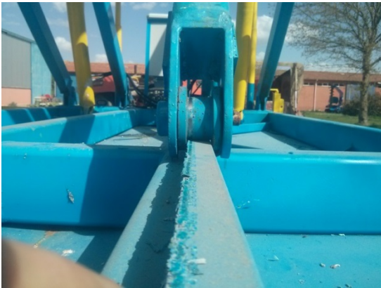
Şekil 10. Makas kollarının yukarı ařađı hareketini sađlayan makara ve ray
