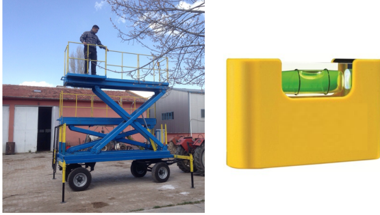
Őekil 6. Meyve hasat platformunun denge ayaklarının kurulması
