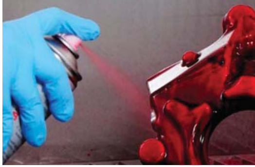
Şekil 3. Sıvı penetrant testinin günümüz uygulamalarından bir örnek (Geni Metal, 2018).
