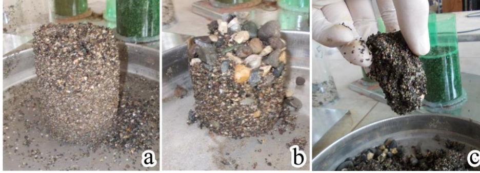
Şekil 6. Uygulama sonuçları (a) 3 nolu numune, (b) 4 nolu numune, (c) 4 nolu numune (zemin tanelerinin birbirine tutunması)
