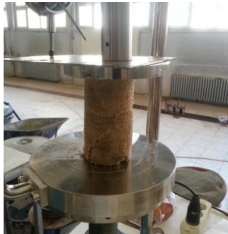
Şekil 12. Serbest basınç deneyine ait fotoğraf
