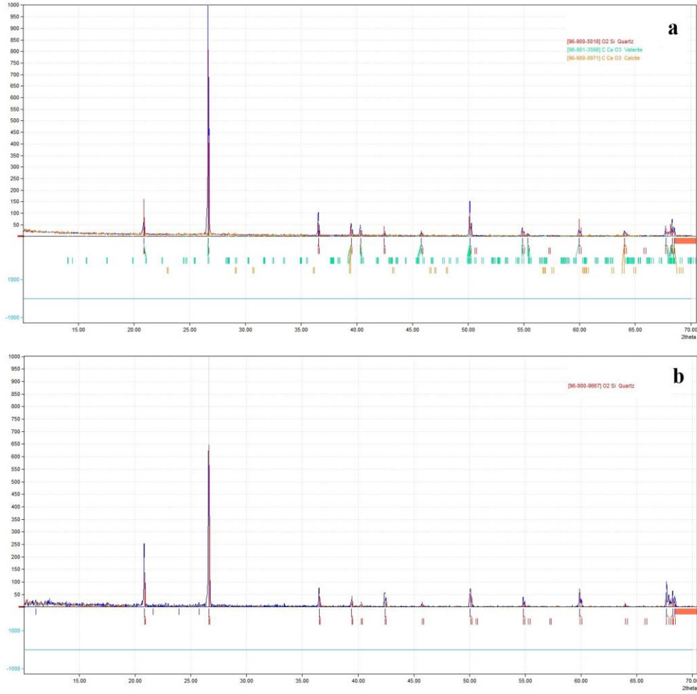
Şekil 11. (a) Uygulama yapılan kum zemin XRD sonuçları (b) uygulama yapılmayan zemin XRD sonuçları
