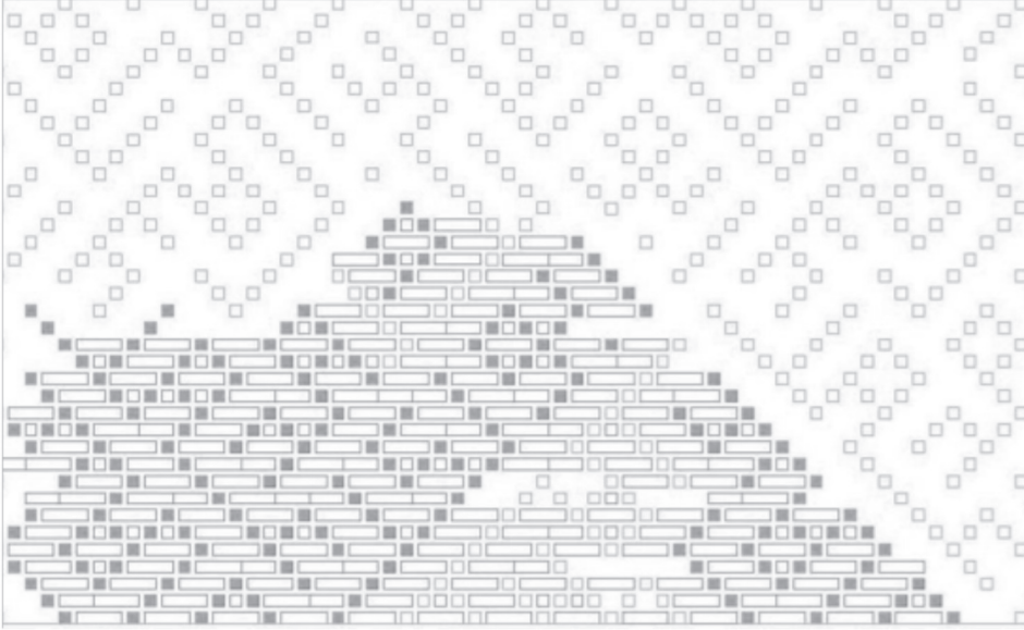
Çizim 5: Kaidenin yüzeyi üzerindeki sırlı tuğlaların photoshop ve autocad programları kullanılarak çözümlenme aşamasında tespit edilen Ebubekir, Ömer, Muhammed yazıları.
