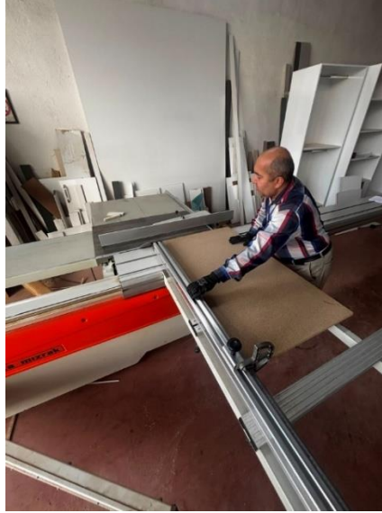
Resim 5. Mobilya atölyesinde levha işleme sırasında elle yönlendirme ve kesici ekipman tehlikeleri
