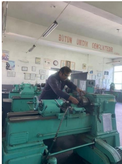
Resim 4. Torna tezgâhında döner parça, talaş ve sıkışma tehlikeleri
