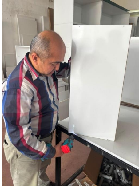
Resim 6. Mobilya montajında elektrikli el aleti kullanımı, parça sabitleme ve delme işlemi
