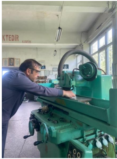
Resim 3. Taşlama tezgâhında parça bağlama ve yakın çalışma sırasında oluşabilecek mekanik tehlikeler
