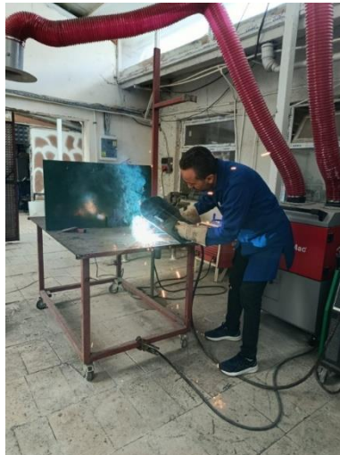
Resim 2. Kaynak uygulamasında kıvılcım, duman ve yakın gözetim gerektiren çalışma düzeni
