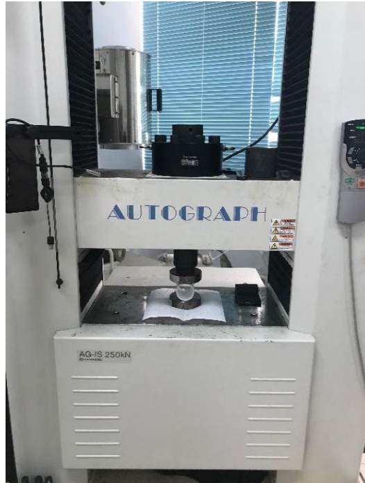
Şekil 4. Basma deneyinde kullanılan cihazın görüntüsü.
