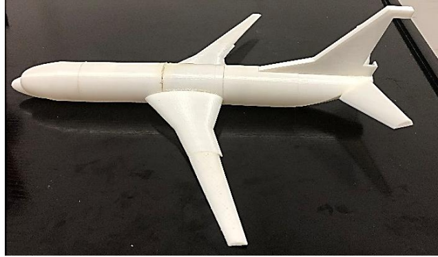
Şekil 5. Üç boyutlu yazıcı ile üretilen Boeing 737-800 model uçak.7
