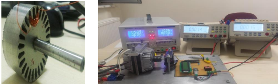
Şekil-1 Sincap kafesli rotor ve deney düzeneği
