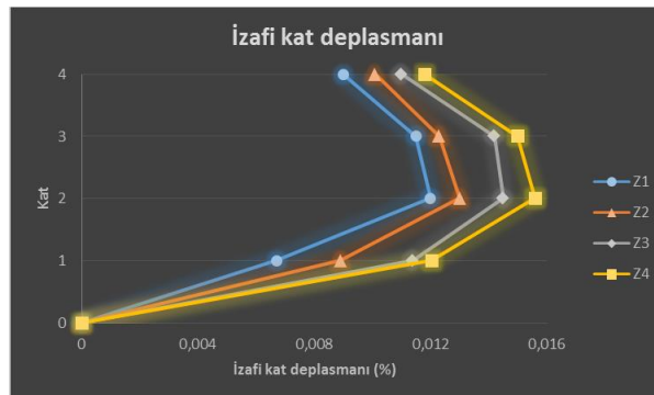
Şekil 10. Farklı zemin sınıfları için bulunan görelî kat ötelemesi değerleri (relative value of storey displacement obtained for different soil classifications)
