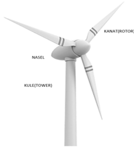
Şekil 3. Rüzgar türbini yapısı
