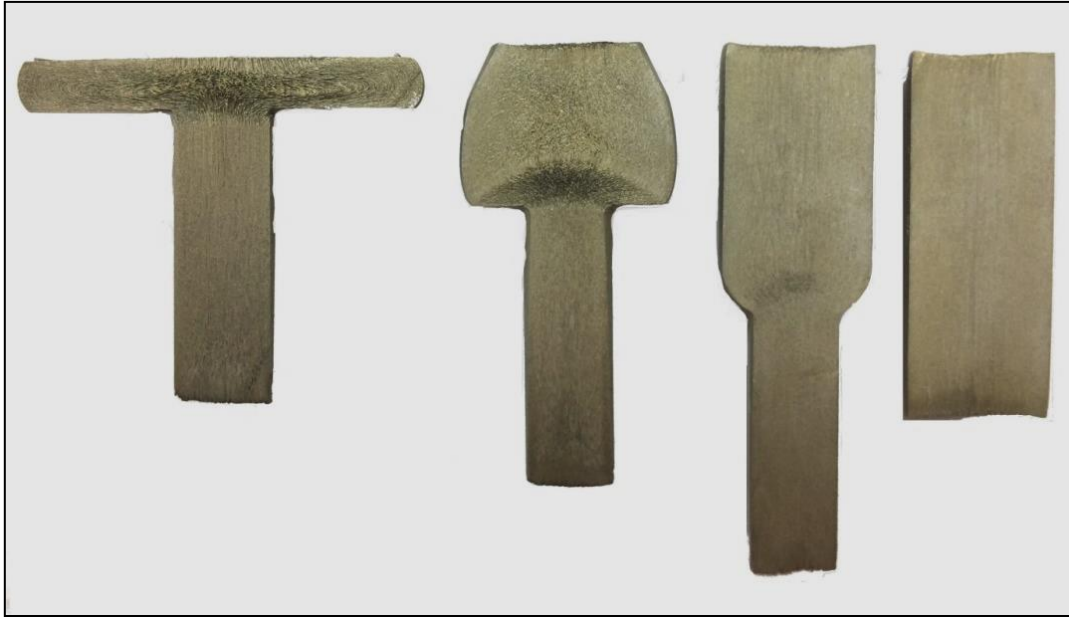
Resim1. Makro dağlanmış operasyon numuneleri
