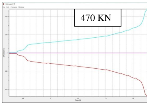
Şekil 7. 2.istasyon kuvvet deplasman (2.Station force – displacement)
