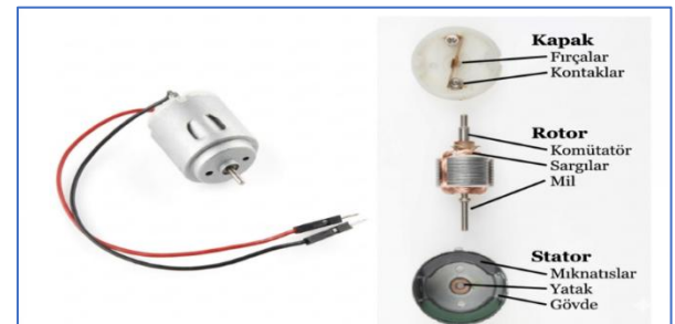
Şekil 1. F.A.I.R. veri seti çalışmasında kullanılan FDA motorunun temel bileşenleri: Armatür, sargılar, fırçalar, komütatör ve stator mıknatısları (Reñones, 2020).
