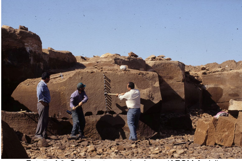
Fotoğraf-6: Ocaktan taşın çıkarılması (AEGM Arşivi)
