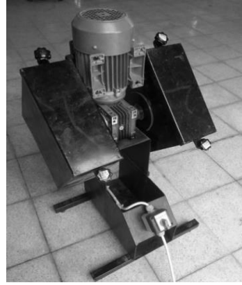
Şekil 4. Pelet Mekanik Dayanıklılık Test Cihazı
