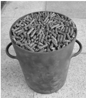
Şekil 3. Pelet Yığın Yoğunluğu Belirleme Kabı
