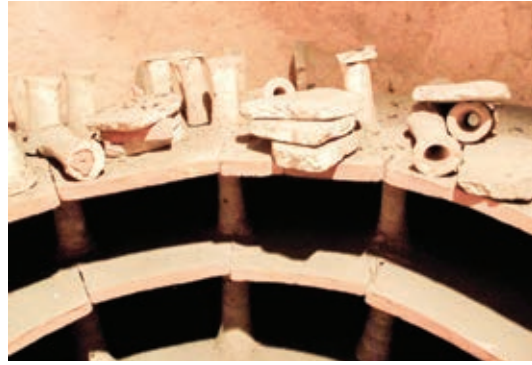
Şekil 10, 11, 12. Geleneksel Odun Fırını Ateşliği ile Gözetleme Deliği, Üst Giriş Bölümü ve Fırın İçi Raf Düzeni (Ertuğrul Çini Fabrikası, Kütahya, 2016)
