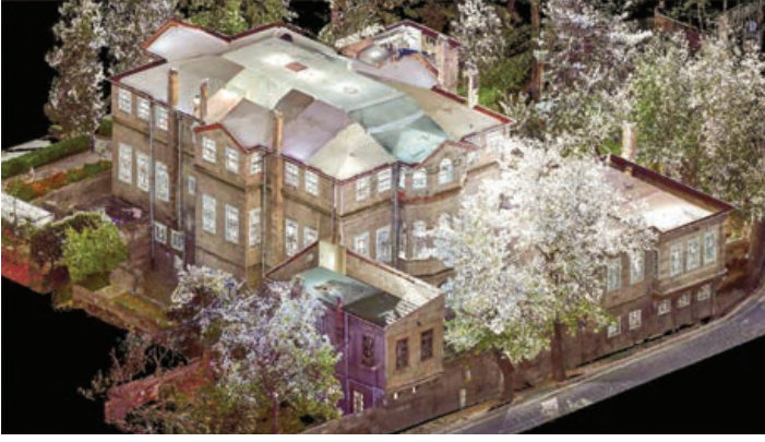
Şekil 13. Renkli 3B nokta bulutu görseli
