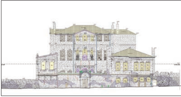
Sekil 28. Konservasyon projesi cephe çizimleri
