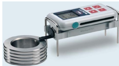
Şekil 4: PS1 yüzey pürüzlülük cihazı
