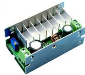
Şekil 8. K101 200W ayarlanabilir dc-dc voltaj regülatör kartı [13]
