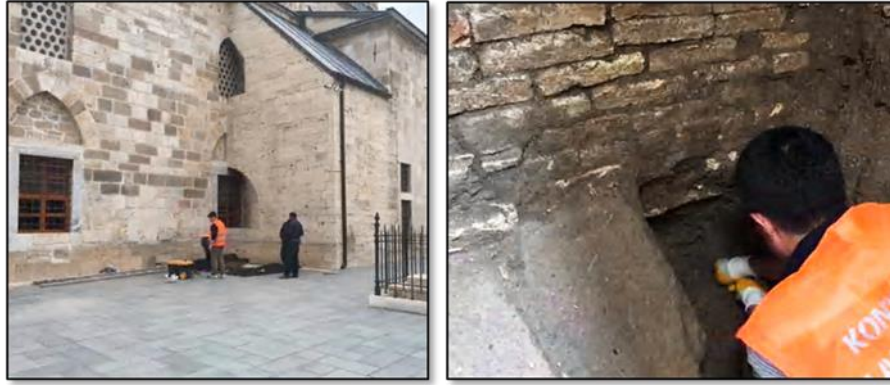
Şekil 2. Yapı beden duvarlarının oturduğu zeminden numune alınması /Celaleddin Rumi Türbesi, Konya [1]
