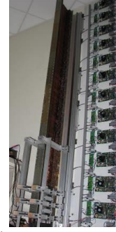
Şekil 2.6 Sabancı Üniversitesi tarafından yapılan, lineer motorla çalışan bir asansör için deneme sürüşü [9].
