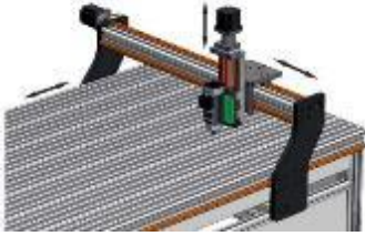
Şekil 2.4 Lineer motorlu bir takım tezgâhi örneği [7].
