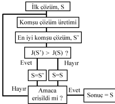
Şekil 1: Tepe tırmanma yöntemine ait akış diyagramı [25].
