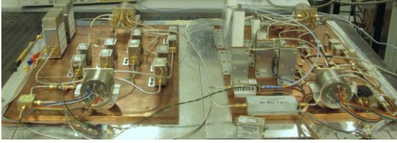
Şekil 5: Bakır blok üzerine mikrodalga malzemelerin montajlanmış hali.
