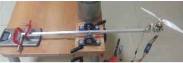
Şekil 11: Kaldırma Kuvveti Ölçüm Test Düzenegi
