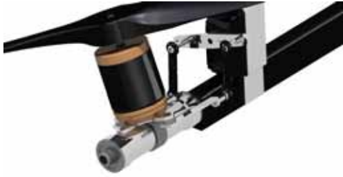
Şekil 3: Rotor döndürme mekanizması
