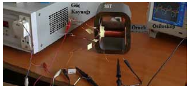
Şekil 5: SST yöntemi ile nüve kayıplarının ölçüldüğü cihazlar.
