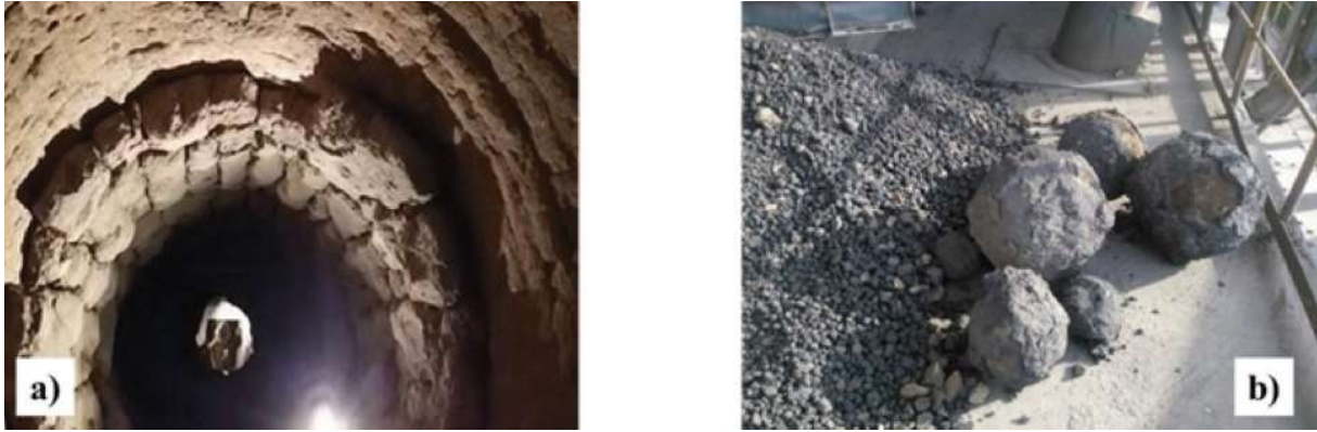
Şekil 6. Döner fırın aşırı anzast oluşumu (a) ve şandel oluşumu (b)
