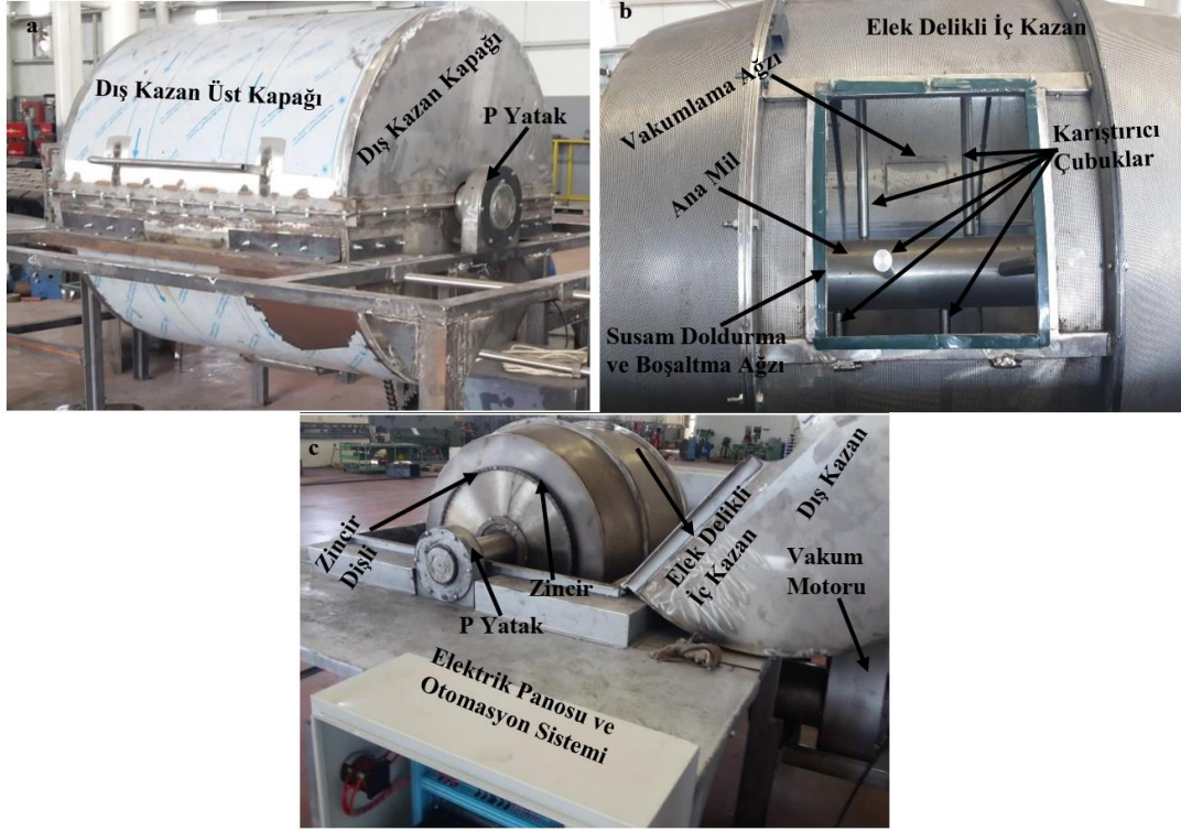
Şekil 1. Susam zarı soyma makinesi a) Makinenin kapalı-çalışır konumu, b) Makinenin karıştırıcı çubukları ve elek delikli iç kazanı, c) Makinenin dış kapağı açılmış konumu ve elektrik panosu ve otomasyon sistemi.
