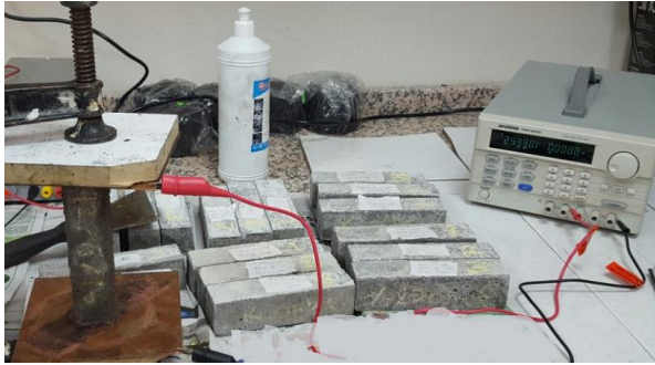
Şekil 2. Elektriksel özdirenç ölçümünde kullanılan deney düzeneği.
